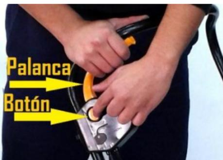
Cuando se suelta la palanca la cortacésped se detiene.
