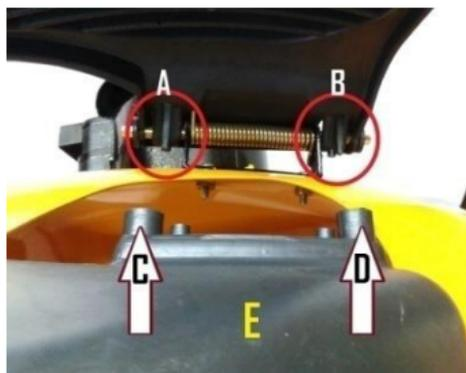
Levantando la tapa lateral observamos que se encuentran 2 patitas (A y B) del lado interno de ésta, las cuales tienen que ser introducidas en los orificios (C y D) que se encuentran en la salida lateral plástica (E), como muestra la imagen.
