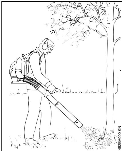
El soplador ha sido diseñado para usarse con una sola mano. Se lleva como una mochila y se usa colocando la mano derecha sobre el mango de control.
