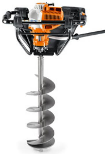
Cómoda hoyadora de un sólo operario para hacer hoyos de hasta 200 mm de diámetro. Potente motor STIHL 4-MIX® de bajas emisiones. Vibraciones reducidas. Con freno de barrena QuickStop, que interrumpe la transmisión de fuerza cuando la barrena se atasca. Para una gran variedad de tareas, desde pequeñas perforaciones hasta toma de muestras del suelo. Barrena no incluida. Se puede complementar la máquina con una variada gama de barrenas.
