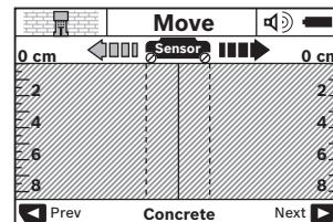
Posicione la herramienta de detección contra la pared y muévala sobre la pared en el sentido de desplazamiento (vea "Instrucciones de utilización", página 13). Los resultados medidos se indican en la pantalla 16 después de una distancia de medición mínima de 4 pulgadas (10 cm). Para asegurarse de lograr resultados de medición correctos, mueva la herramienta de detección de manera lenta y completa sobre el objeto que supuestamente se encuentra dentro de la pared.
