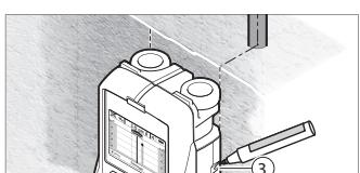
Para marcar exactamente el objeto en la pared, mueva la herramienta de detección hacia la izquierda o hacia la derecha hasta que el objeto encontrado esté posicionado debajo de uno de los bordes exteriores. Cuando el objeto encontrado esté indicado directamente debajo de la línea de puntos derecha g en la pantalla 16, máquelo con el auxiliar de marcado derecho 3.
