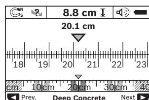
En el ejemplo, el modo de regla muestra la misma situación que en la figura D: Tres barras de acero igualmente separadas por la misma distancia. En el modo de regla, se puede determinar la holgura entre los centros del objeto detectado.
