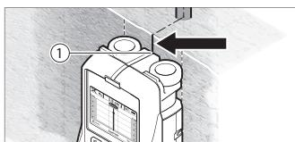
Cuando un objeto sea indicado directamente debajo de la línea central k en la pantalla 16, como en el ejemplo, máquelo tópicamente con la guía de marcado superior 1. Esta marca sólo será precisa cuando el objeto esté posicionado exactamente vertical en la pared, ya que el alcance del sensor está ubicado ligeramente debajo de la guía de marcado superior.
