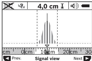
La profondeur de l'objet et, dans la mesure du possible, les types de matériaux de l'objet, sont indiqués sur l'écran. La profondeur de mesure maximum est de 6 po.
