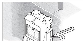
Pour obtenir un marquage exact de l'objet sur le mur, déplacez l'outil de détection vers la gauche ou vers la droite jusqu'à ce que l'objet trouvé soit positionné en dessous de l'un des bords extérieurs. Quand l'objet trouvé est indiqué directement au-dessous du trait en tirets vers la droite g sur l'écran 16, marquez-le de façon approximative avec le guide de marquage de droite 3.
