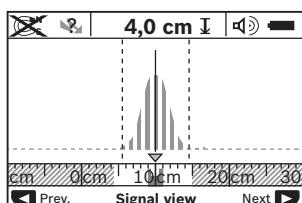
Se muestran la profundidad del objeto y los tipos de material del mismo (tan lejos como sea posible). La máxima profundidad de medición es de 6 pulgadas.
