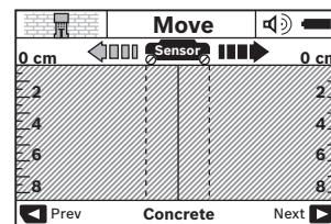
Positionnez l'outil de détection contre le mur et déplacez-le le long du mur dans le sens de la course (voir « Consignes d'utilisation », à la page 13). Les résultats mesurés sont indiqués sur l'écran 16 après le parcours d'une distance minimum de 4 po (10 cm). Pour assurer des résultats de mesure corrects, déplacez lentement et entièrement l'outil de détection au-dessus de l'objet assumé dans le mur.
