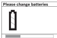
Cuando la indicación de advertencia "Please change batteries" (Favor de cambiar las baterías) se muestre en la pantalla 16, los ajustes se almacenarán y la herramienta de detección se apagará automáticamente. Ya no será posible realizar mediciones. Cambie las baterías.
