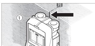
Quand un objet est indiqué directement au-dessous de l'axe central k sur l'écran 16, comme dans l'exemple, marquez-le de façon approximative avec le guide de marquage supérieur 1. Cette marque ne sera précise que quand l'objet sera positionné de façon exactement verticale dans le mur, étant donné que la plage de fonctionnement du capteur est située un peu en dessous du guide de marquage du haut.
