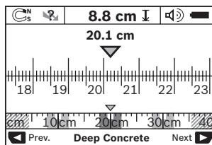
Dans l'exemple, le mode avec règle montre la même situation que dans la Figure D : Trois barres en acier équidistantes. Dans le mode avec règle, la distance entre les centres des objets détectés peut être déterminée.
