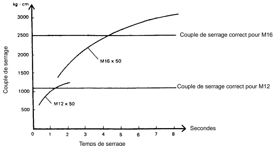
Tenez l'outil fermement et placez la douille sur le boulon ou l'écrou. Mettez l'outil en marche et faites fonctionner la machine sur la durée correspondant au couple désiré.
