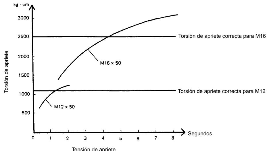
Sostenga la herramienta firmemente y coloque la llave de vaso sobre el perno o la tuerca. Haga girar la herramienta y efectúe el apriete durante el tiempo correcto.
