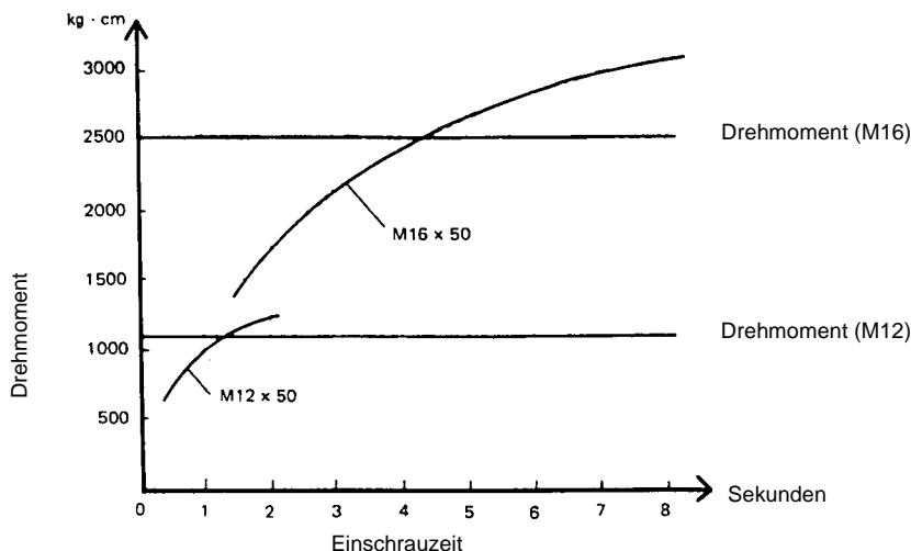
Halten Sie die Maschine fest und setzen Sie den Steckschlüsseleinsatz auf die Schraube oder Mutter. Ziehen Sie unter Berücksichtigung der Einschraubzeit die Schraubverbindung an.
