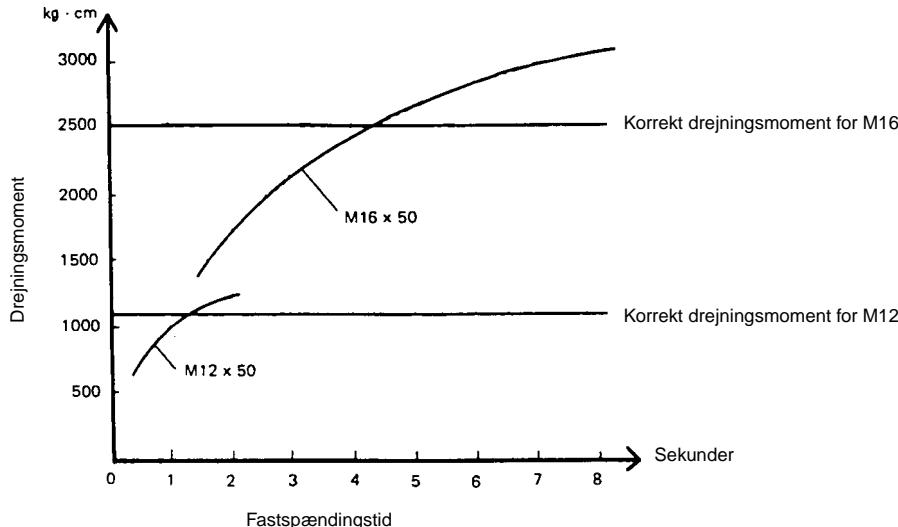
Hold maskinen fast med begge hænder og placér slagtoppen på bolten eller møtrikken. Start maskinen og lad den arbejde den korrekte spændetid.
