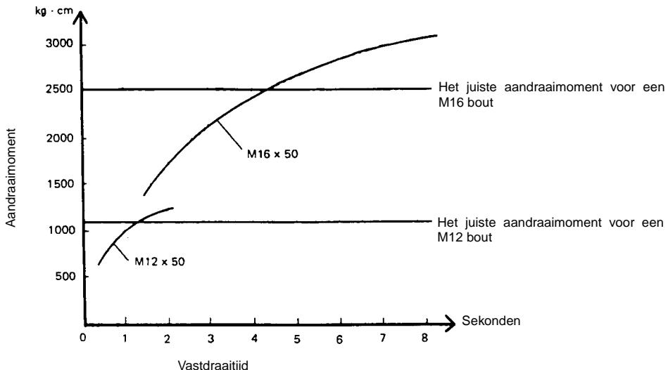
Houd het gereedschap stevig vast en plaats de dop over de bout of moer. Schakel het gereedschap in en draai de bout en moer in de juiste vastdraaitijd vast.
