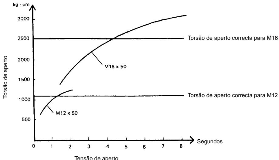
Segure a ferramenta com firmeza e coloque a chave de caixa sobre o perno ou a porca. Ponha a ferramenta a funcionar e efectue o aparafusamento durante o tempo correcto.
