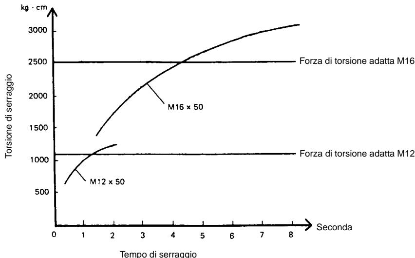
Tenere l'utensile ben fermo e piazzare la bullone sopra il bullone oppure sopra il dado. Mettere l'utensile in moto e stringere il bullone oppure il dado a seconda del tempo necessario.
