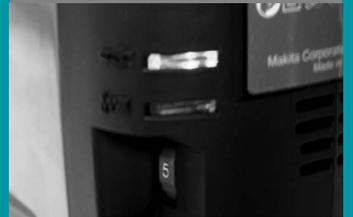
La luz L.E.D. de potencia/servicio indica cuando reemplazar las escobillas ó si hay falla en el interruptor ó el cable
